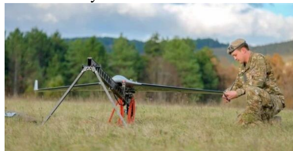
UAS Belin na kolejovém odpalovacím zařízení s operátorem slovinských ozbrojených sil
