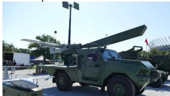
Vozidlo 4×4 Waran systému Gladius s namontovaným taktickým průzkumným bezpilotním prostředkem FT-5
