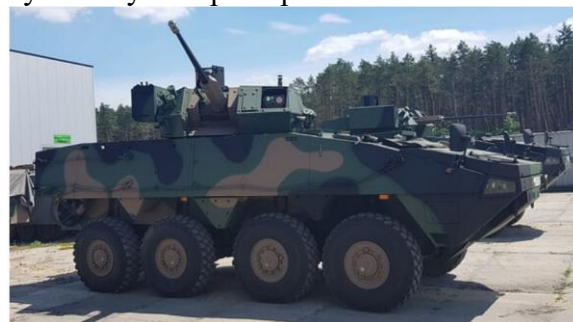
Dálkově ovládaná zbraňová stanice ZSSW-30 ráže 30 mm se stane hlavní zbraní budoucích i současných vozidel OT a BVP, která nahradí věže Hitfist 30P s posádkou
