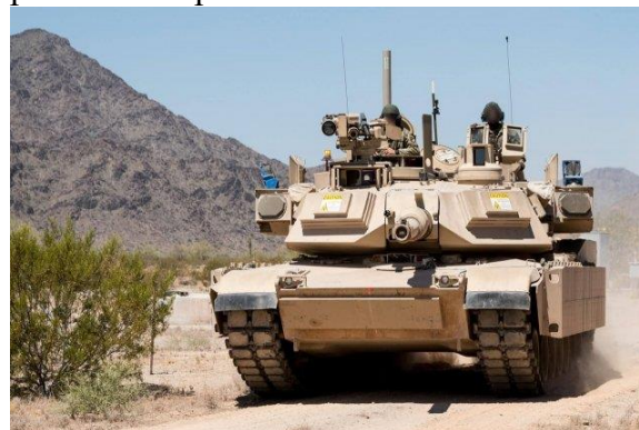
Tank Abrams (U.S. Army) s instalovaným izraelským systémem Trophy Active Protection System
